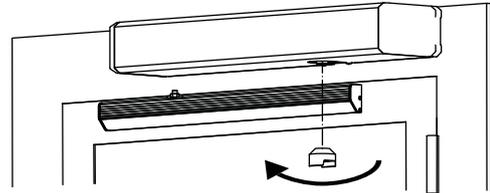
Fissaggio braccio/ Fastening the arm / fixation bras/
