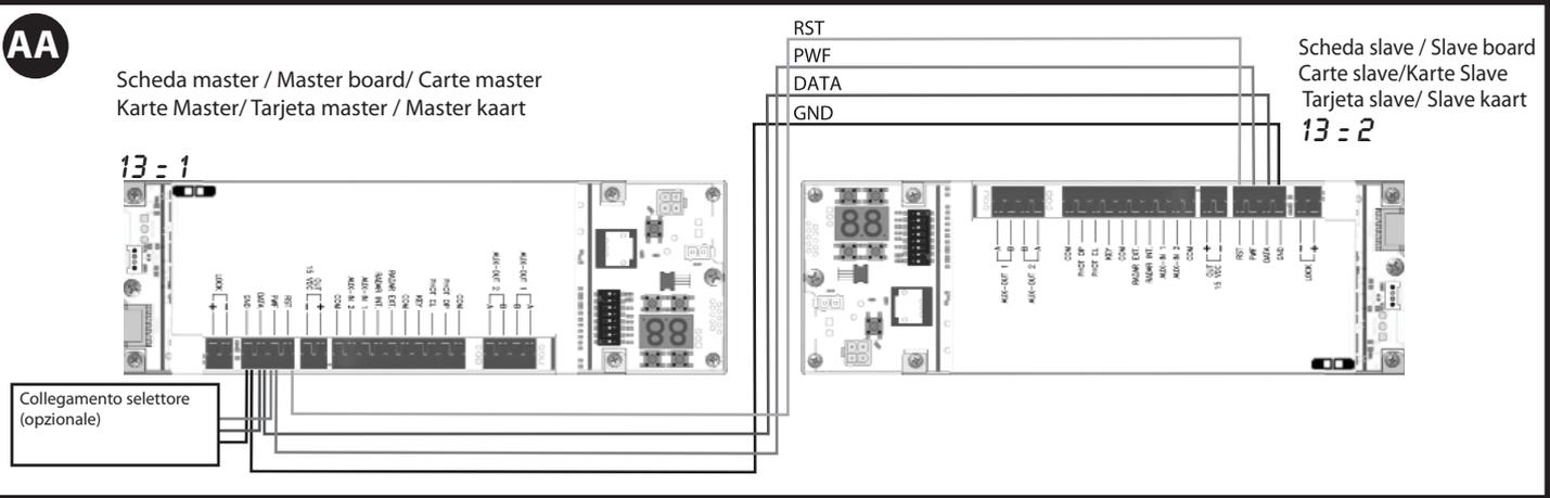
**AC** Collegamento ad uso interblocco / Connection for interlocking feature
