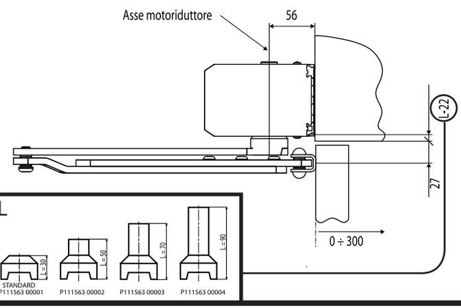
**E1** Fissaggio braccio all'anta /Fastening the arm to the door leaf/ Fixation bras sur vantail / Befestigung des Arms am Flügel / Fijación brazo a la hoja / Bevestiging arm aan de deur
